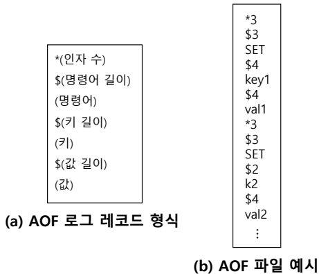
<그림 3> AOF 로그 레코드 형식 및 예시
